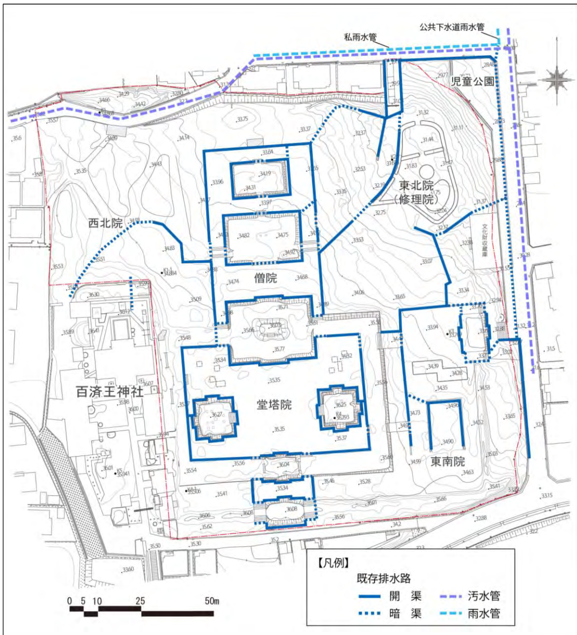
図 7-8 排水現状と公共下水道（青線：史跡整備に伴う排水路） ※排水ルート及び規模の詳細は基本設計において、検討を行う。
