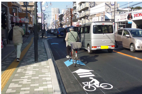
車道混在の「自転車通行帯」(枚方市駅まであと5分の場所=昨年12月新設)
