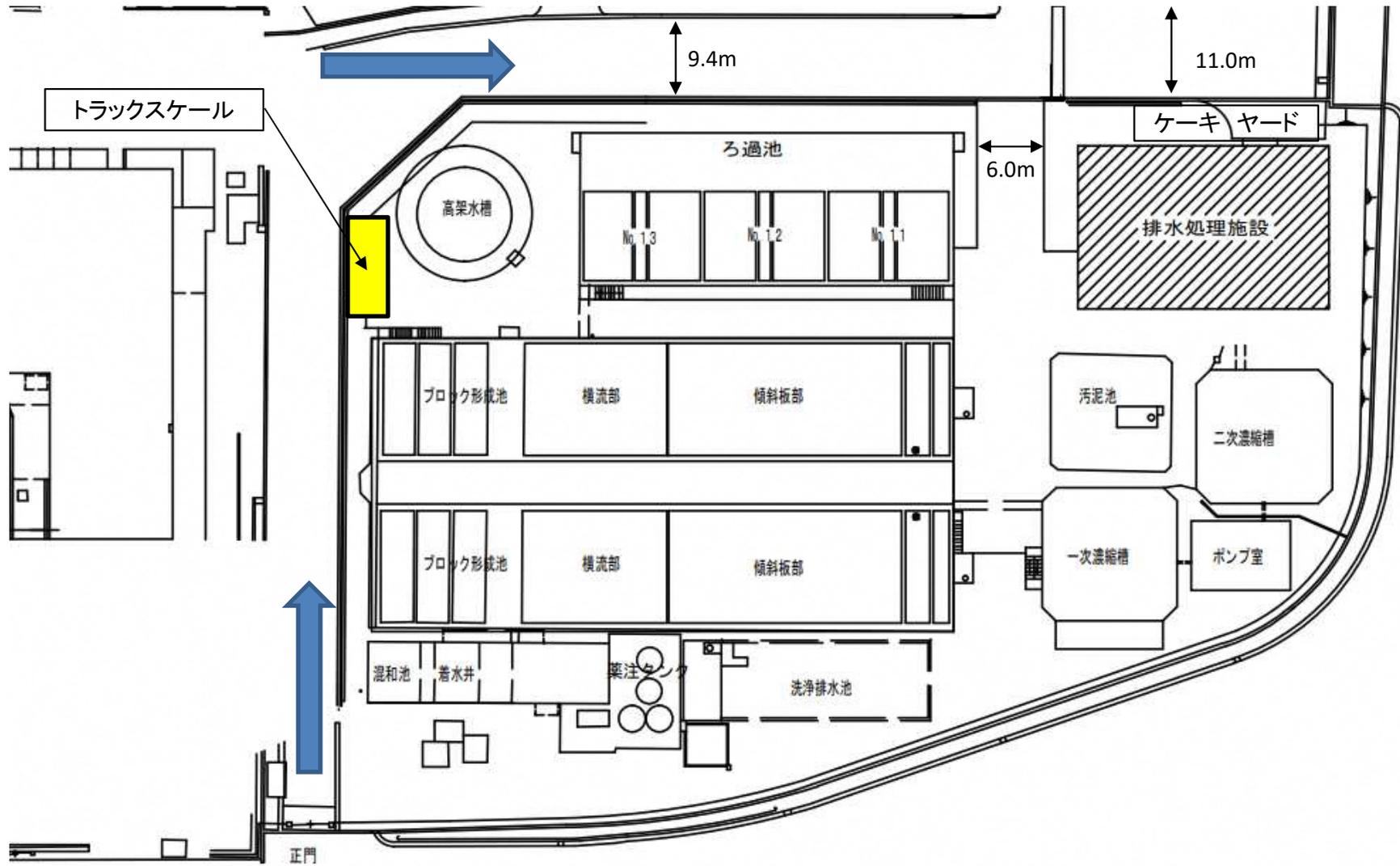
現場参考図2(排水処理施設1F 浄水発生土保管場所正面図)
