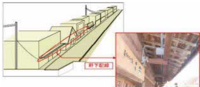
図 2-6 軒下配線方式のイメージ
