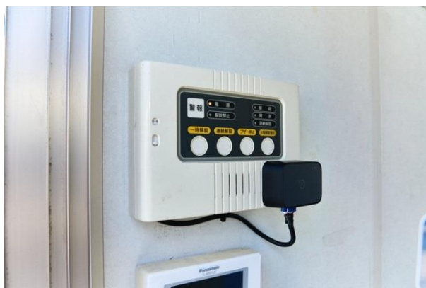
▲製品使用イメージ。園内のオートロック制御装置に取り付け、アプリからの解錠信号を受信。
