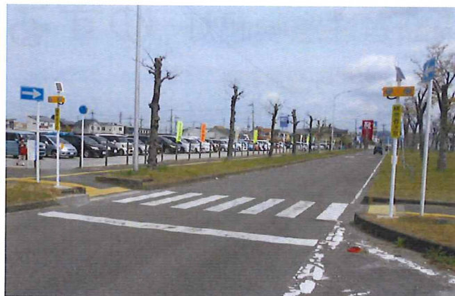
通常の「手をかざす」ではなく横断者をドップラーセンサで感知するしくみの「ゆずるくん」設置例です。2022年4月撮影
